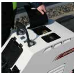
Tapas de fácil apertura que ofrecen acceso a los puntos de comprobación diarios
