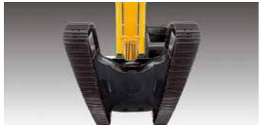
Marco de sección en caja reforzado, soldado de acero de baja tensión y alta resistencia. Garantiza seguridad y resistencia contra impactos externos al circular por terrenos accidentados y trabajar en sitios húmedos mediante paneles de acero de alta resistencia a la tracción, con rodillos superiores e inferiores y protectores de orugas de gran durabilidad.
