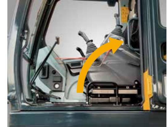
Las nuevas empuñaduras de joystick para un control preciso se han equipado con interruptores dobles.
