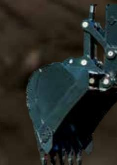
El varillaje de la cuchara sellado y ajustable proporciona menos desgaste de los pasadores y casquillos, así como un funcionamiento silencioso. El diseño incluye la durabilidad del eslabón de la cuchara y funciones anti desgaste. Placas de refuerzo adicionales en la sección del filo. La cuchara reforzada está fabricada con acero más grueso y placa lateral adicional.
