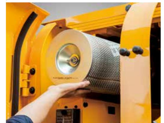
La caja de control eléctrico y el filtro de aire están centralizados en uno o el mismo compartimento para facilitar el mantenimiento.
